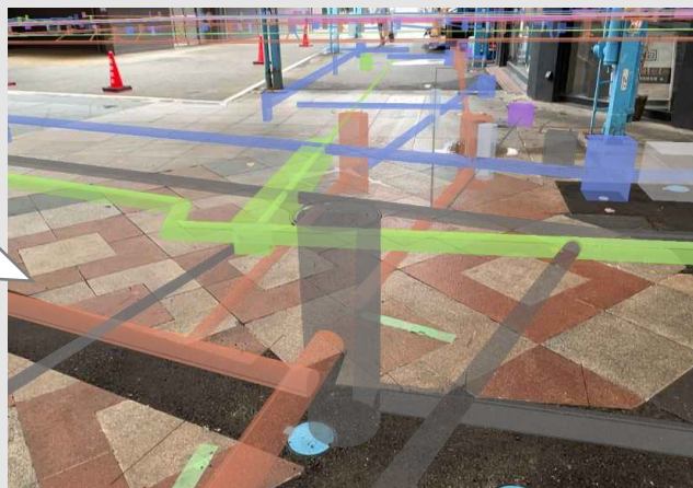
【地下埋設物3DモデルのAR表示】
