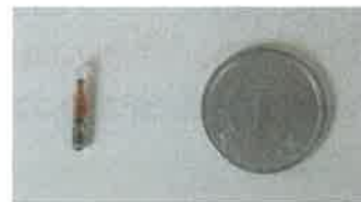
直径1.2mm、長さ8mm程度の円筒形の電子標識器具です。
