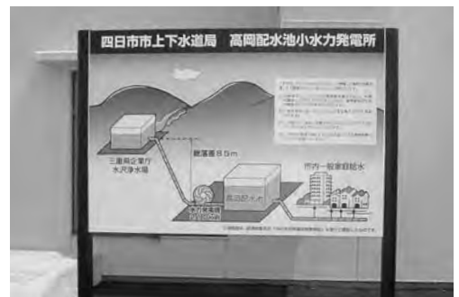
高岡配水池小水力発電所
